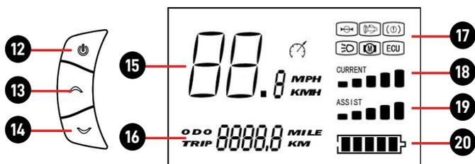
(12). Bouton ON/OFF (13). Changement de mode d'assistance et kilométrage (14). Changement de mode d'assistance et kilométrage (15). Vitesse instantanée (16). ODO : kilométrage total / TRIP : kilométrage du trajet (17). Indicateurs lumières, freins et erreurs (18). Puissance batterie (19). Niveau d'assistance (20). Niveau de batterie
