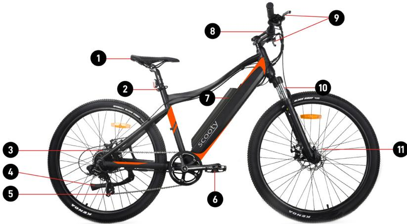
(1). Седло (2). Регулировка седла (3). Задний дисковый тормоз, двигатель и редукторы (4). Сцепление (5). Переключатель (6). Педаль (7). Съемный аккумулятор (8). Экран (9). Ручки тормоза (10). Подвеска (11). Передний дисковый тормоз
