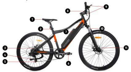
(1). Sela (2). Ajuste da sela (3). Travão de disco traseiro, motor e engrenagens (4). Embraiagem (5). Descarrilador (6). Pedal (7). Bateria amovível (8). Tela (9). Pegas de travão (10). Suspensão (11). Travão de disco frontal
