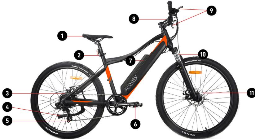
(1). 鞍座(2)。鞍座调整(3)。后盘式制动器、马达和齿轮(4)。拐杖(5)。变速器(6)。踏板(7)。可拆卸电池(8)。屏幕(9)。刹车手柄(10)。悬架(11)。前盘式制动器
