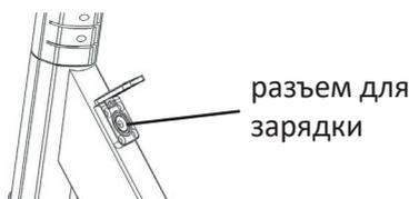
1. Поднимите крышку порта зарядки и убедитесь, что разъем зарядки не содержит воды или других жидкостей, объектов, которые могут вызвать короткое замыкание или помешать правильному и надежному подключению вилки зарядного устройства. Затем вставьте конец зарядного кабеля в зарядный порт (9). **ПЕРЕД** подключением другого конца к источнику питания. **ПЕРЕД** подключением вилки к электросети убедитесь, что вы правильно подключаете зарядный блок к устройству.
