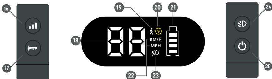
(16). Modo de cambio de marcha (17). Bocina (18). Velocidad instantánea (19). Modo de velocidad 1 (20). Modo de velocidad 2 y 3 (21). Indicador del nivel de la batería (22). Indicador de tipo de velocidad (23). Indicador de activación de la luz (24). Botón de activación de la luz (25). Botón ON/OFF
