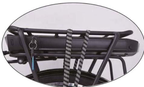
Rode a chave para a esquerda para desbloquear a bateria e retire-a. Use a pega na parte de trás para deslizar a bateria para fora por baixo do suporte. Para substituir a bateria, faça o inverso.
