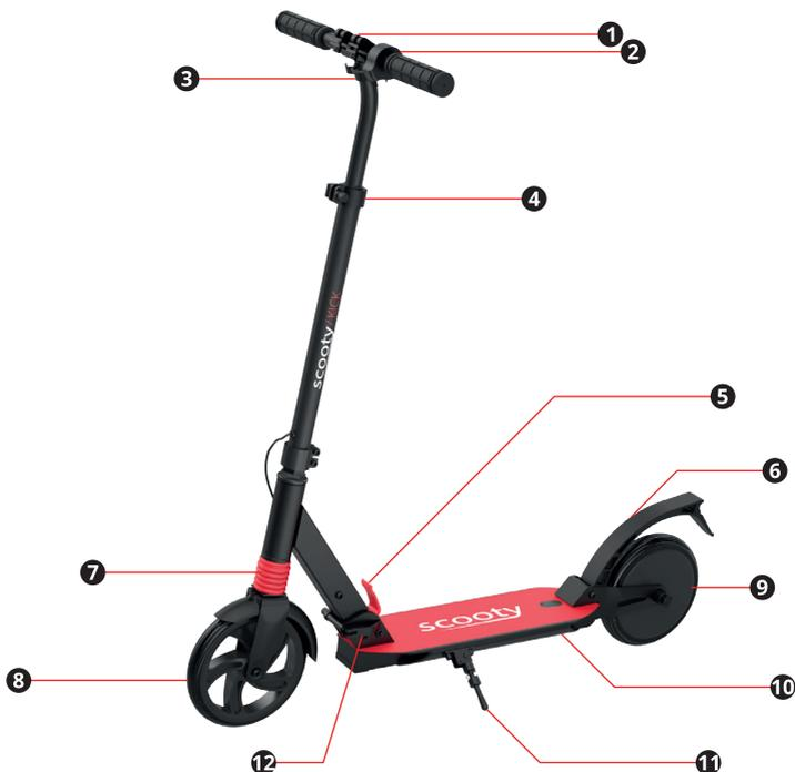
(1). Boucle de serrage de poignées (2). Frein électronique (3). Support pour poignées (4). Boucle de réglage de hauteur du guidon (5). Bouton de déverrouillage (6). Frein arrière (7). Suspension avant (8). Roue non-motrice (9). Roue motrice (10). Port de charge et bouton On/Off sous la trottinette (11). Frein arrière (12). Levier de verrouillage.
