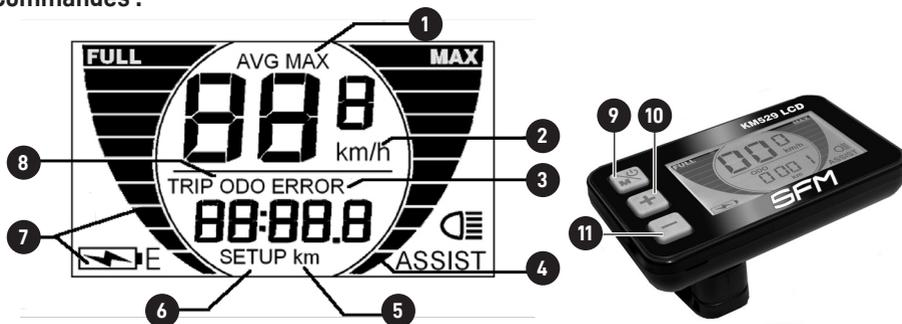
(1). Vitesse moyenne / Vitesse max (km/h) (2). Vitesse (km/h) (3). Code d'erreur (4). Niveau d'assistance (5). Distance parcourue (6). Setup (7). Niveau de charge de la batterie (8). Distance parcourue (TRIP) / Distance totale (ODO) (9). Bouton MODE / marche/arrêt (10). Bouton + (11). Bouton -
